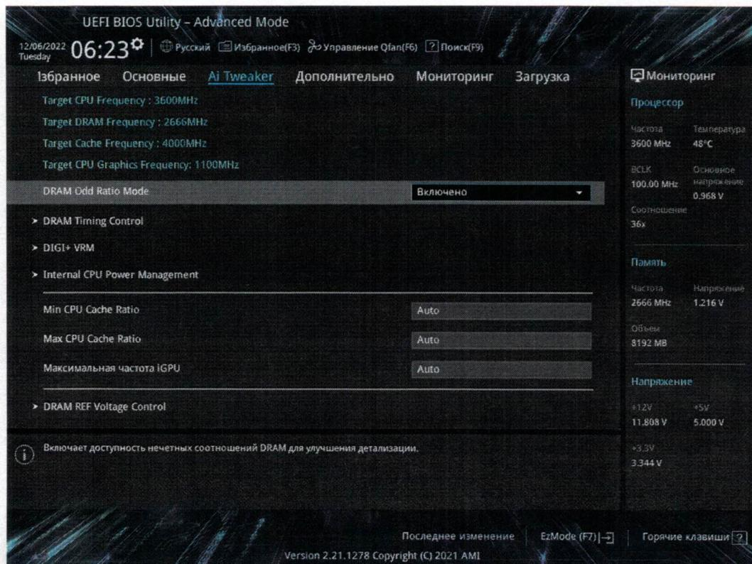
**DRAM Odd Ratio Mode** (Включено) - для обеспечения лучшей детализации. Параметры конфигурации: (Отключено) (Включено)
