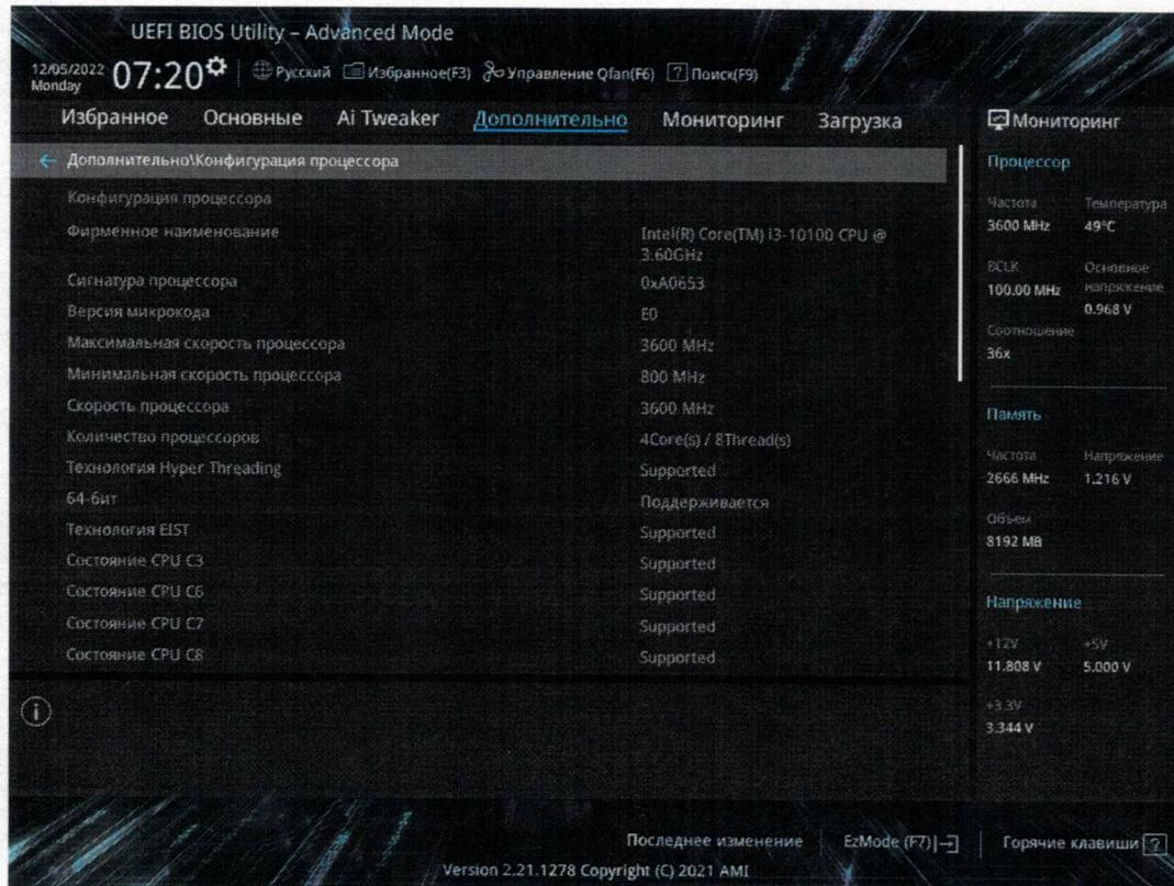
В верхней половине экрана собрана информация об установленном процессоре: Наименование, сигнатура, максимальная и минимальная частота процессора, количество ядер, поддерживаемые технологии и т.д.
