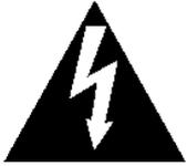
Данный знак предупреждает о неизолированном напряжении, которое несет опасность удара электрическим током при открытой крышке
